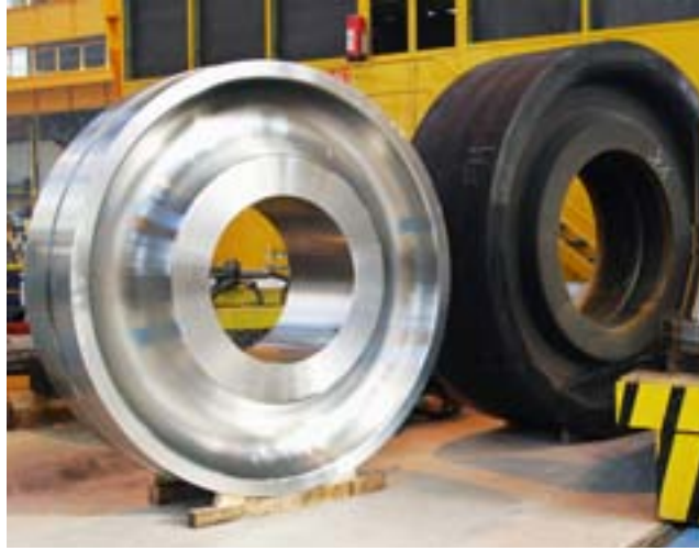
Radscheibe nuklear | Rotor Disc, Nuclear
