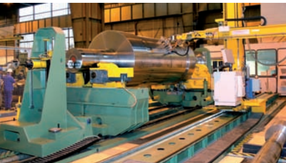
Automatisierte Ultraschallprüfung für langgeometrische Teile Automated Ultrasonic Testing for Long-Shaped Parts
