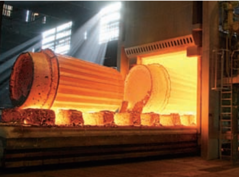
Rohblock bereit zum Schmieden | Ingot ready for Forging
