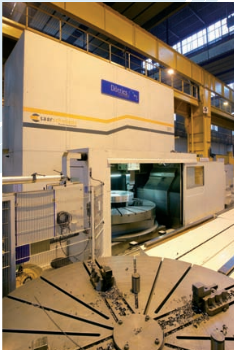
Vertikaldrehmaschine mit Wechselplanscheibe Vertical Lathe with Exchangeable Face Plate
