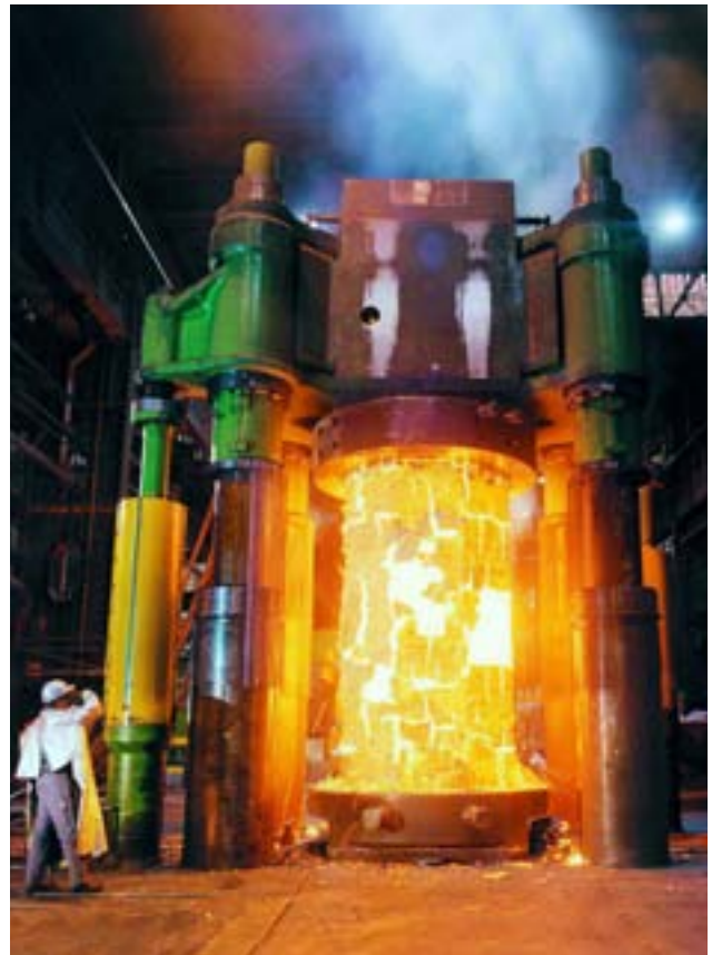
85 MN-Freiformschmiedepresse 85 MN Open Die Forging Press
