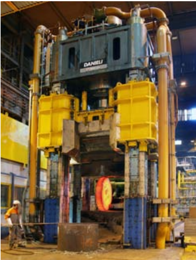
40 MN-Freiformschmiedepresse 40 MN Open Die Forging Press
