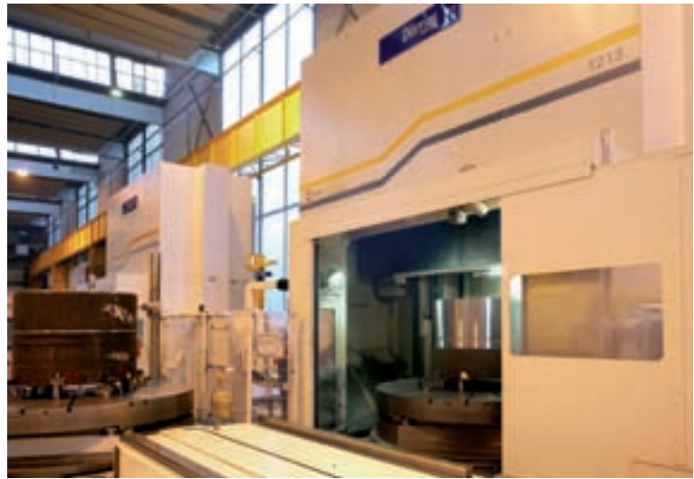
Vertikaldrehmaschine mit Wechselplanscheibe für geringste Rüstzeiten Vertical Lathe with Exchangeable Face Plate to Allow very fast Tooling
