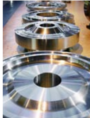
Kompressor- und Gasturbinenscheiben Compressor and Gas Turbine Discs
