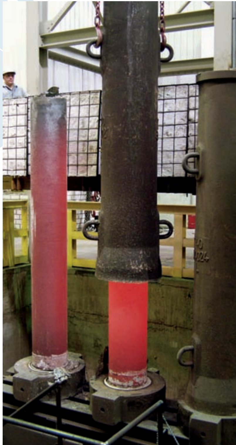
VI-Elektroden nach dem Abguss | VIM electrodes after pouring
